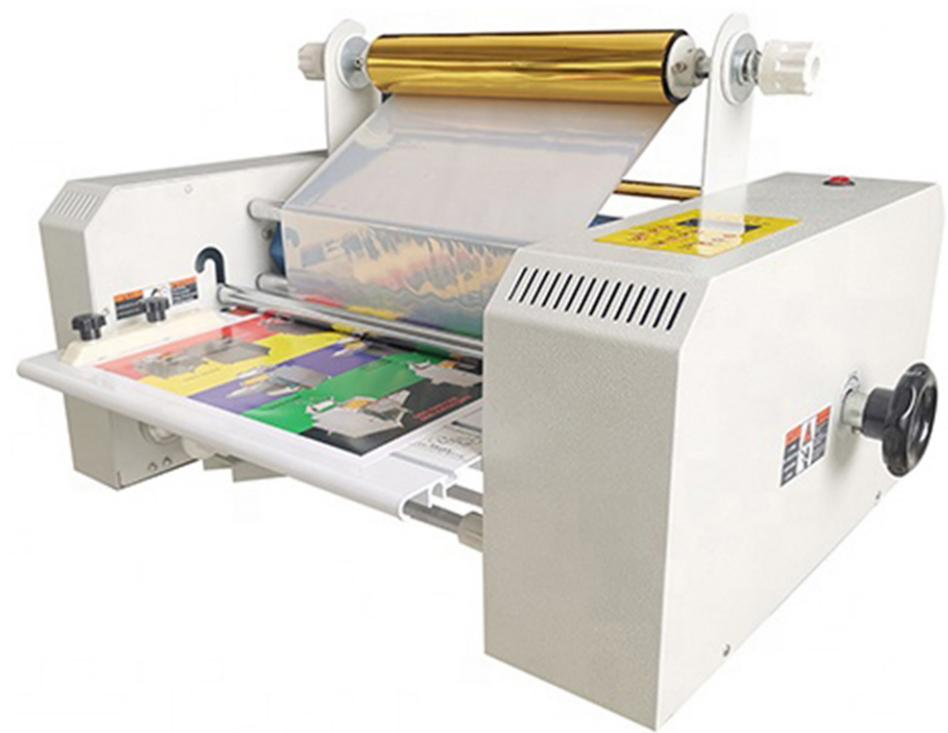
Επαγγελματικό μηχάνημα Foiling (Ψηφιακή Χρυσοτυπία - χωρίς χρήση κλισέ). Το υλικό (Foil) «κάθεται» όπου υπάρχει toner οπότε το μηχάνημα λειτουργεί μόνο σε ψηφιακές εκτυπώσεις (Toner). Χειροκίνητη τροφοδοσία με μέγιστο πλάτος χαρτιού 35cm, μέγιστο πλάτος ρολού 31.5cm, εύκολη αλλαγή των ρολών, δυνατότητα ρύθμισης της θερμοκρασίας και της ταχύτητας λειτουργίας, μεγάλη ποικιλία μεταλλικών χρωμάτων στα αναλώσιμα ρολά, μεταλλικό τροχήλατο stand και εξ'ολοκλήρου στιβαρή μεταλλική κατασκευή.
